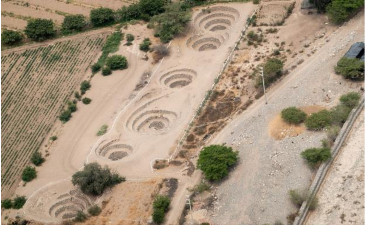
Abb. 25. Cantalloc, Peru. Kontrollschächte (ojos de aqua) auf dem Cerro Blanco im oberen Teil des Systems ( https://en.wikipedia.org/wiki/Puquios ).
