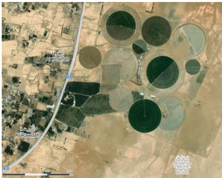
Abb. 18. Das Abpumpen von Wasser aus Tiefbrunnen für kreisförmige Bewässerungssysteme führt zur Zerstörung alter Qanaten (die Gegend von Layla, im zentralen Teil der Arabischen Halbinsel).
